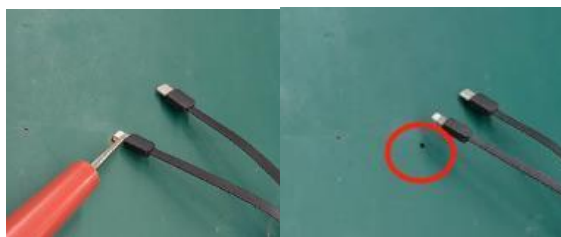
图 9、图 10：放电火花和灼烧黑点
