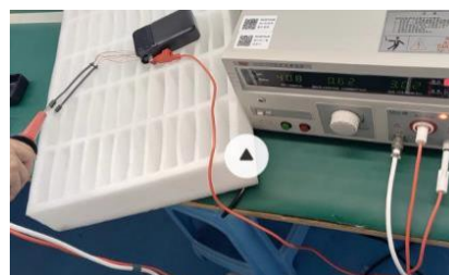
图 13：高电压施加在绝缘垫上，通过
