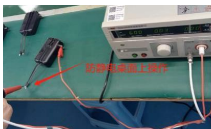
图 12：高电压施加在防静电桌面上，不通过
